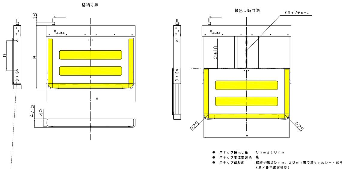
本体取付4箇所：M10細目（P=1.25）です。ボルトが内部へ突き出すと動作不良になりますので、ボルト首下長さは【取付ステーの板厚+ワッシャ類の厚み+6mm】以下としてください。
