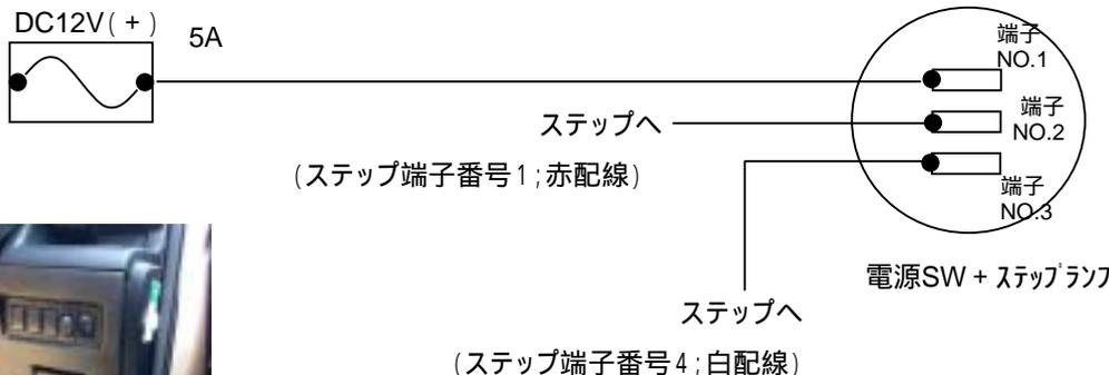
ステップの電源SWは、車両のスイッチ蓋に取付けるか、適当な所に取付けてください。
